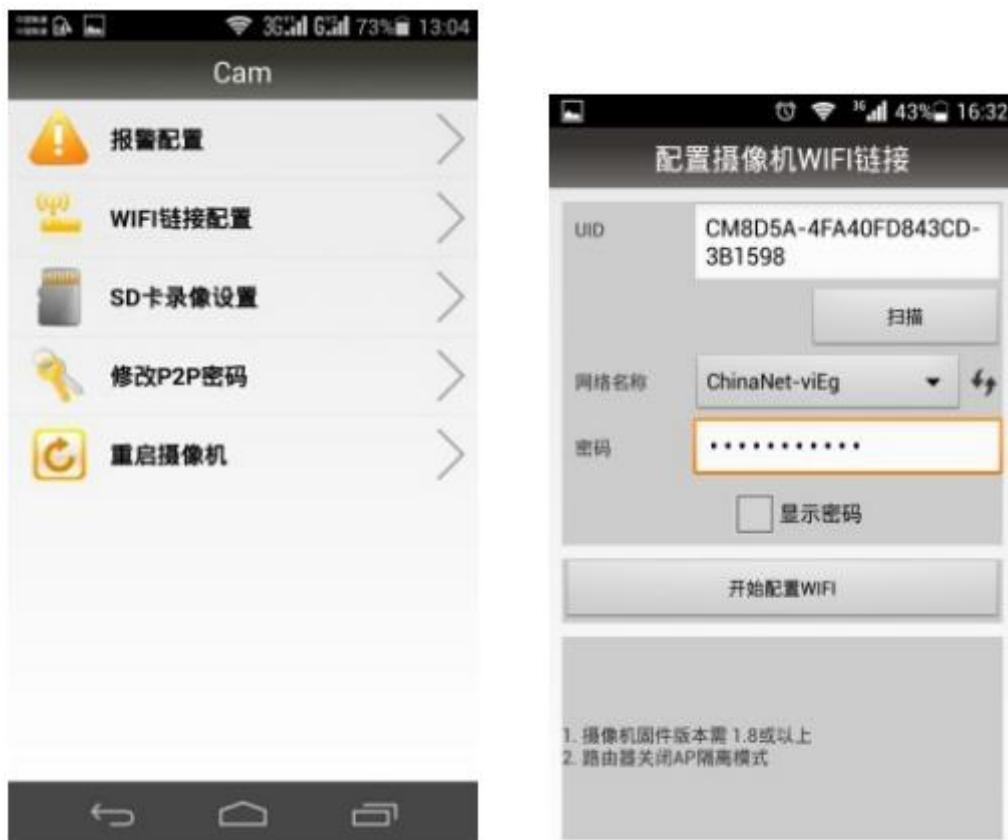
点击”WIFI 链接配置”，网络名称处选择本地路由器，输入本地路由器 WIFI 密码，再点击开始配置 WIFI，既可以将摄像机配置到路由器上，完成后就可以远程查看了。
